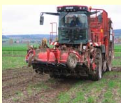
Abb. 1: 6-reihiger Köpfrödebunker, Befahrung Spur an Spur, Reifeninnendruck 200-300 kPa, ca. 34 Mg Gesamtmasse (halb beladen, Rodeaggregat ausgehoben). Diese Belastung mit dem Rübenroder erfolgte zusätzlich zu den üblichen Bewirtschaftungsmaßnahmen mit leichten Versuchsmaschinen.
