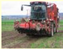
Abb. 1: Köpfrödebunker (6-reihig), Befahrung Spur an Spur, Reifeninnendruck 200-300 kPa, ca. 34 t Gesamtmasse (halb beladen, Rodeaggregat ausgehoben).
