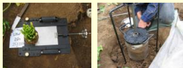
Abb. 1: Entnahme ungestörter Bodenproben incl. Rübenkörper; August 2004, Variante LBW.
