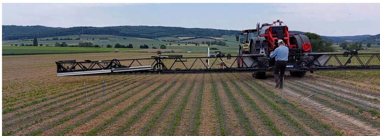
Abb. 1. Streifenapplikation mit Lebensmittelfarbe zur Testung der Applikationsgenauigkeit.
