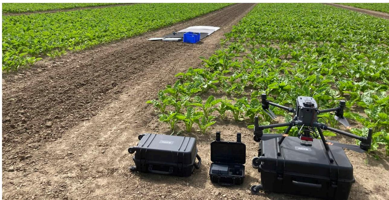
Abb. 3. An der Drohne (DJI M350 RTK) wird eine multispektrale Kamera (Micasense RedEdge-P) installiert. Die Kamera wird in 4 Flügen einmal direkt nach unten ausgerichtet und dann bei einem Neigungswinkel von  $20^\circ$  jeweils einmal in Richtung der Sonne geflogen, einmal von der Sonne abgewandt geflogen und einmal mit der Sonne in der Flanke geflogen, um unterschiedliche Beleuchtungs- und Beobachtungswinkel zu generieren.
