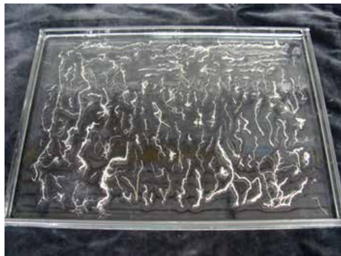
Abb. 3: Vorbereitung der Bildanalyse. Nach dem Wurzelwaschen werden die Wurzeln auf einer Glasplatte ausgelegt. Per Scan erfolgt die Bestimmung von Wurzellänge und -dicke. Mithilfe dieser Daten wird die Wurzellängendichte berechnet.
